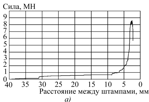
Рис. 11. Изменение силы деформации (а), пересечение волокон контуром детали (б)
