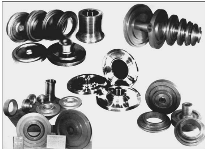
Рис. 155. Изделия из гранул современных жаропрочных никелевых сплавов для авиакосмической техники, морских ГТД, ГТД систем транспортировки газа и нефти, энергетики
