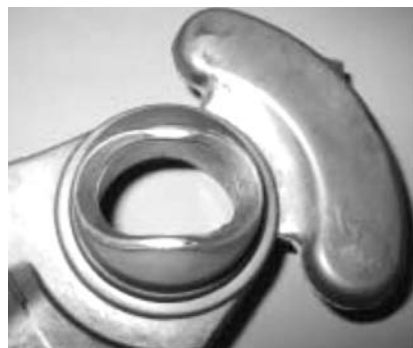
Рис. 130. Отливка кронштейна передней подвески с литниковой системой
