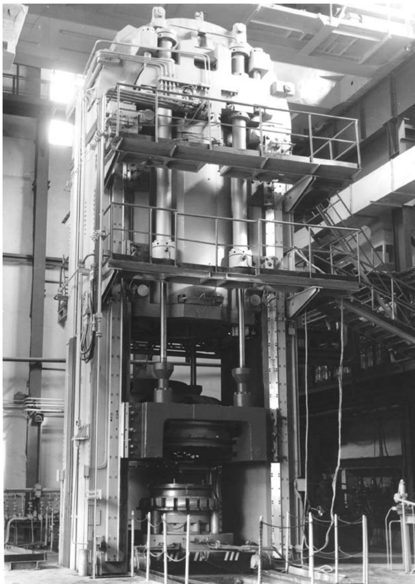
Рис. 154. Газостат с осевой силой 400 МН конструкции ВНИИметмаш–ВИЛС–КЗТС
