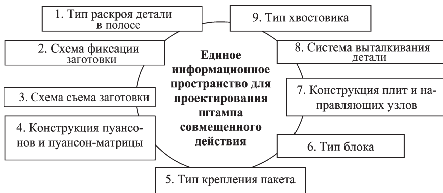
Рис. 46. Возможности пользователя по управлению конфигурированием проектируемых штампов совмещенного действия
